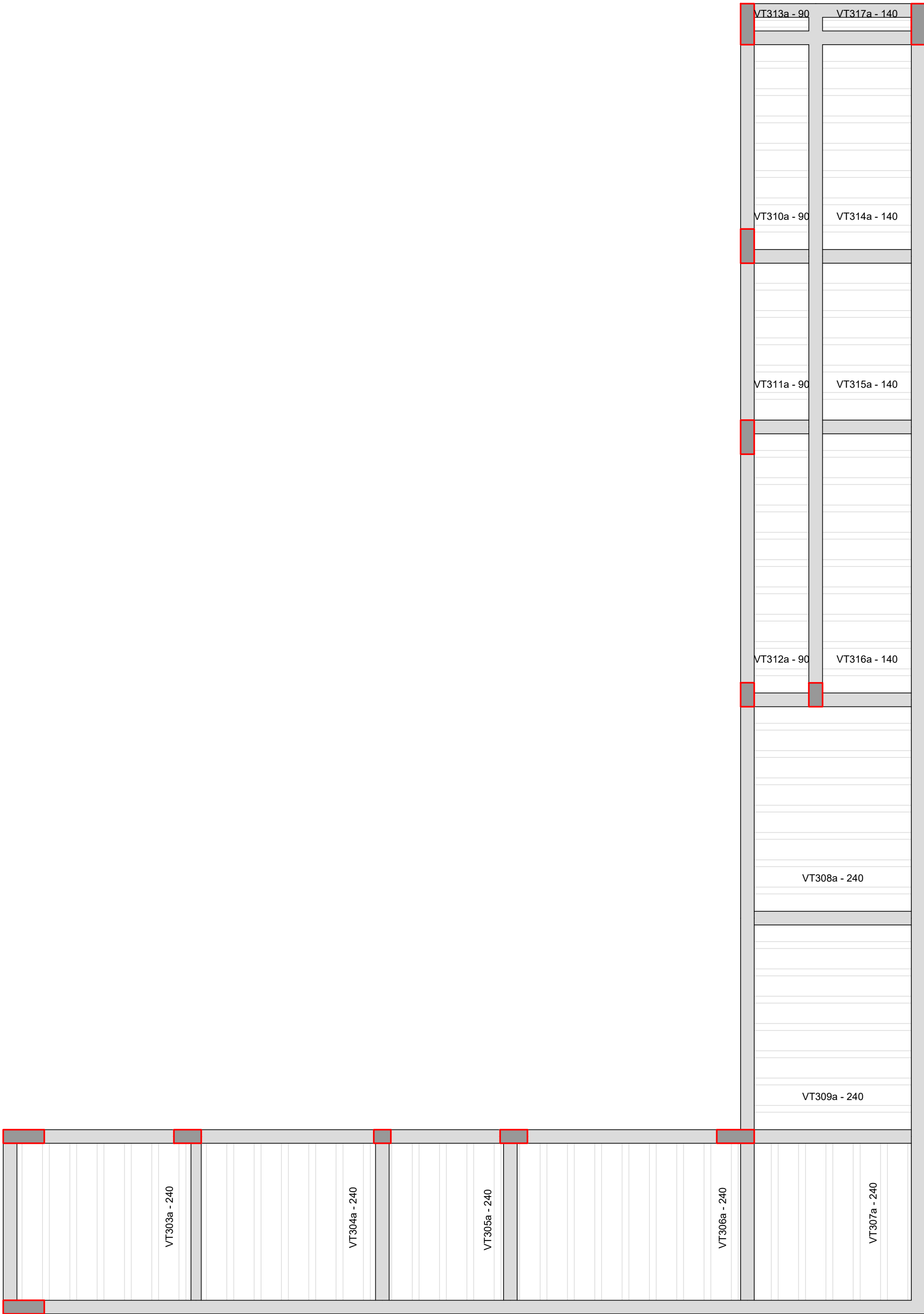
Planta de vigotas pré-moldadas
